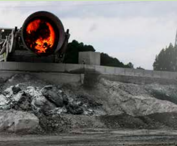
Gieten van vloeibare metaalslakken voor luchtafkoeling.
