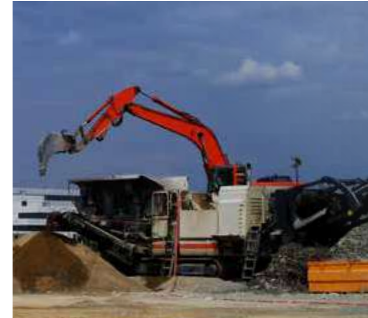
Mobile brekinstallatie aan het werk op bouw- en sloopwerf.
